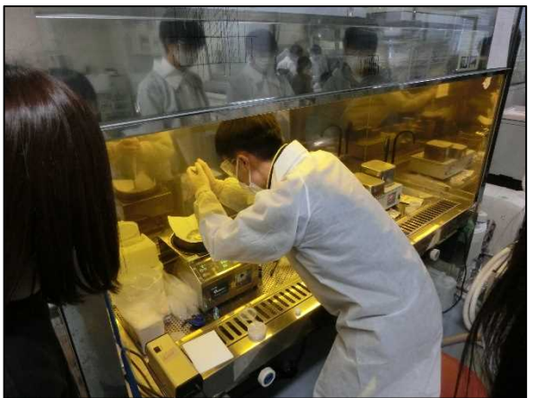
スピコート法で塗布している様子
