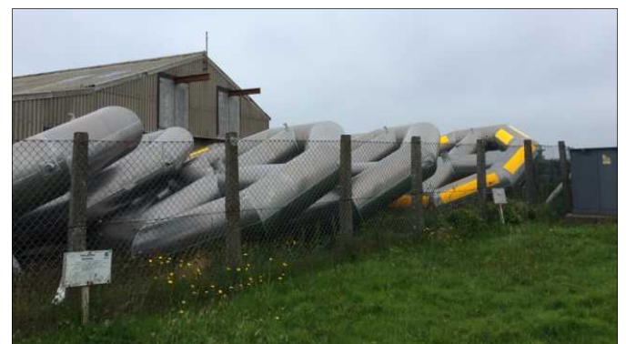
波力を利用した発電機械 (point absorber energy converter system) の一部。現在は実験を終えて保管されている。
